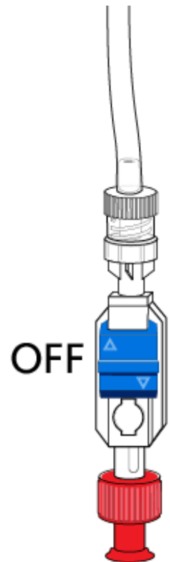
Figura 2. Interruptor de caudal y tapón desechable
