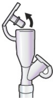
Figura 7. Abra el tapón en el extremo del conector tradicional (izquierda) y ENFit (derecha)
