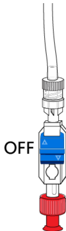
Рисунок 2. Выключатель потока и одноразовый колпачок
