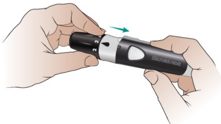
Рисунок 7. Установите крышку обратно на скарификатор
