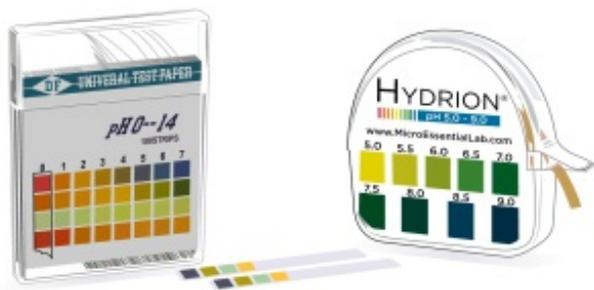
Рисунок 3. Пластиковые полоски для определения уровня рН (слева) и бумажные полоски для определения уровня рН (справа)
