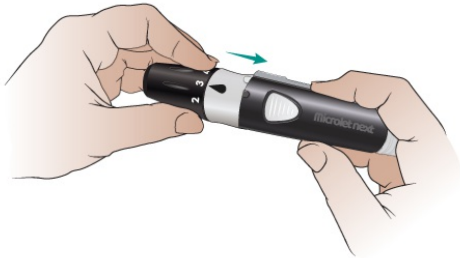
图 7. 将端帽装回采血器
